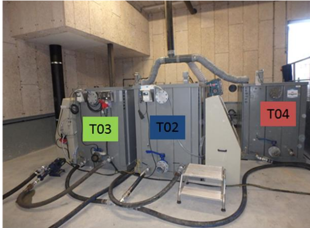
Afbeelding 1-2 Pilotopstelling Kaumera-extractie op rwzi Apeldoorn
